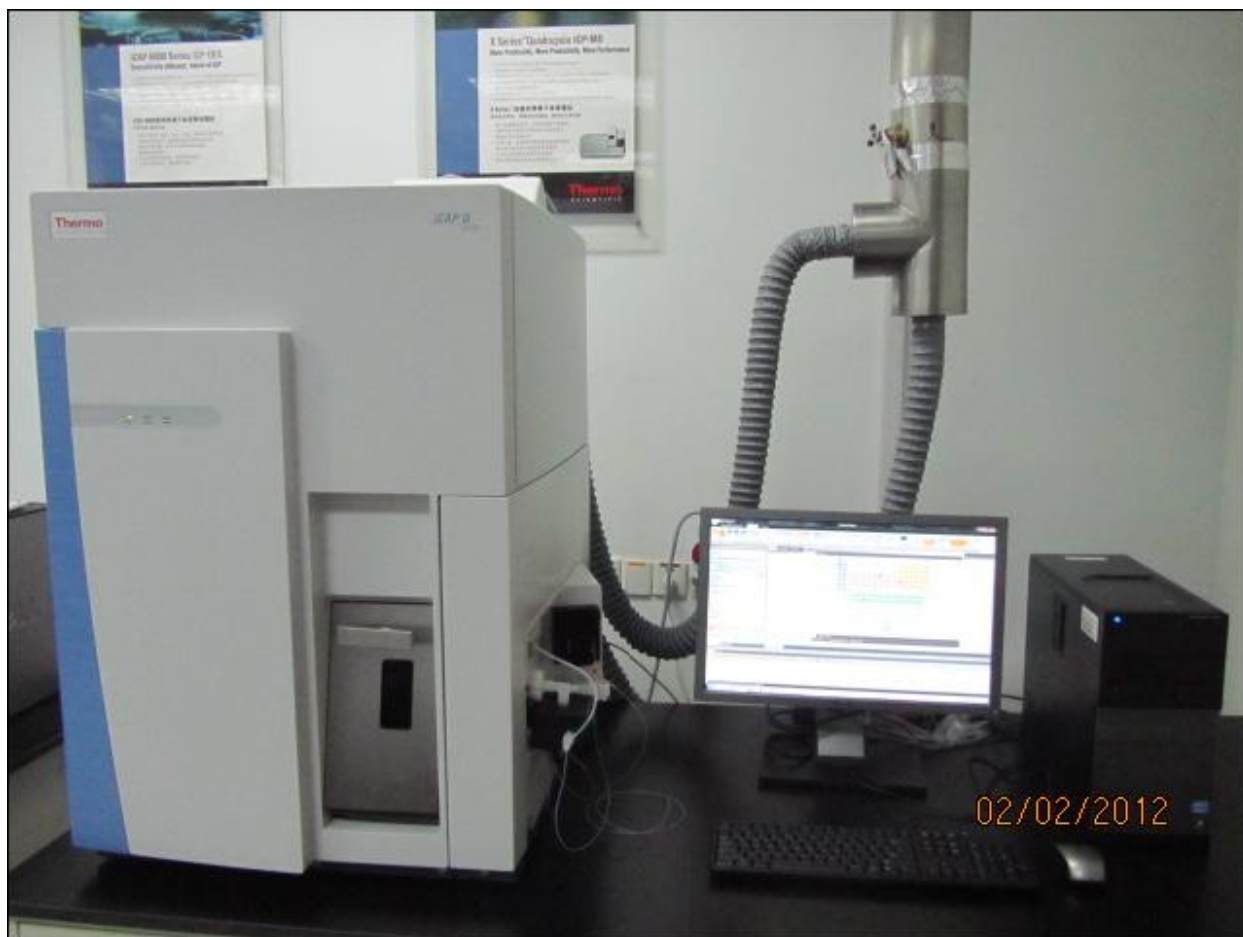
仪器安装后通风管与仪器位置实物图，供参考
