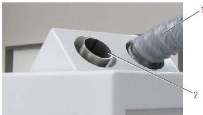
1: 等离子体排风口 2: 电路热量排风口
